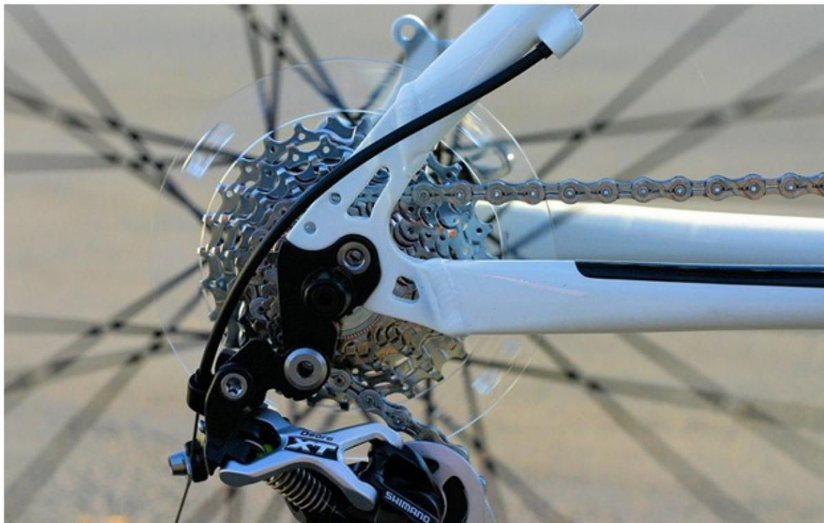
Fig: 14- Back derailleur of gear bi-cycle.
